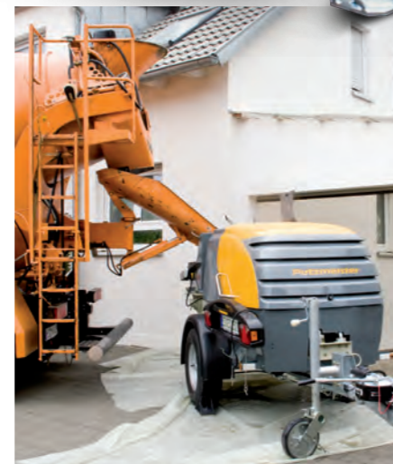
Для перекачки раствора из автобетоносмесителей предусмотрен удобно спроектированный бункер.
