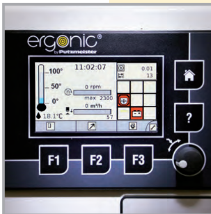
Наглядный графический дисплей EGD (Ergonic® Graphic Display)
